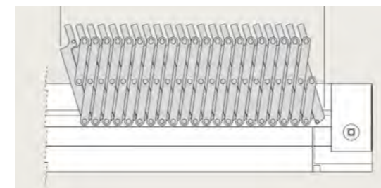
Lamellene pakkes kompakt for maksimal åpning av taket
